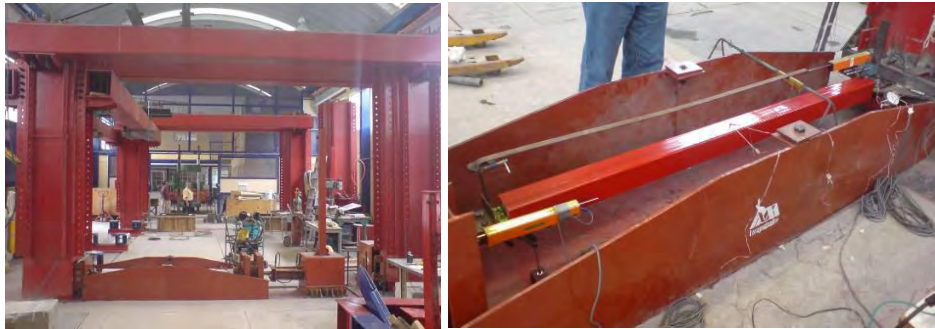
Figura 0.11. Dispositivo de carga para contravientos desadheridos UAM-A
