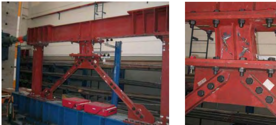
Figura 0.9. Dispositivo placa atiesada ensayado en Cenapred (foto cortesía del Cenapred, Tena 2003)
