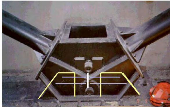
Figura 0.10. Dispositivo tipo viga propuesto por Ortega (foto cortesía de Gustavo Ayala, Tena 2003)
