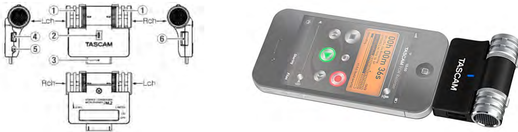
Figura 5.11 Micrófonos condensadores stereo, marca TASCAM, modelo iM2.
