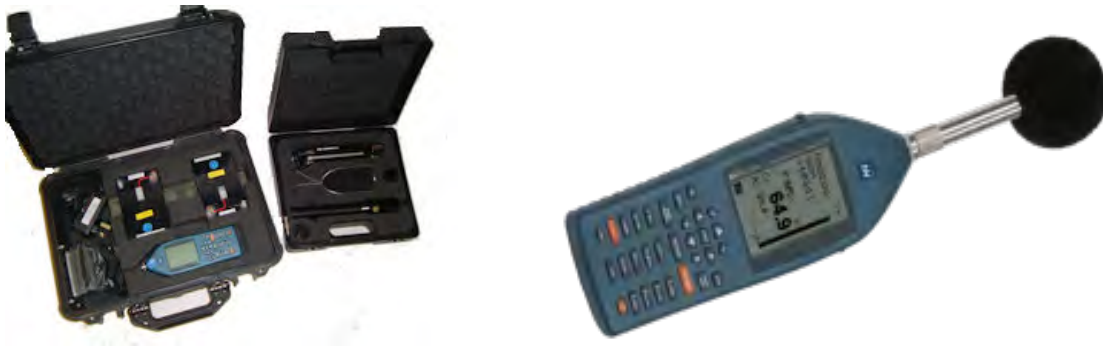
Figura 5.13 Sonómetro integrador NORSONIC, modelo Nor140. Fuente: www.norsonic.com
