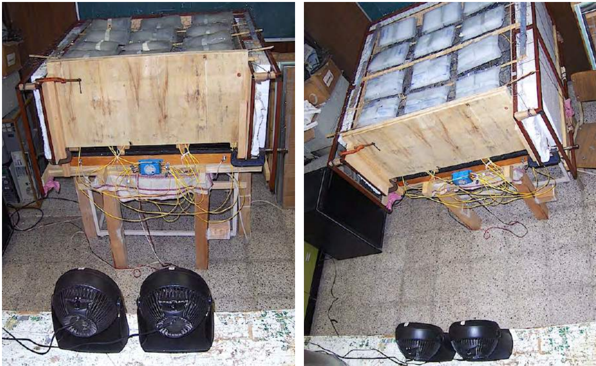
Figura 9.54: Vista general del conductímetro de gran formato durante la prueba de ventilación. Se observa la posición de los ventiladores y la placa fría porosa en la parte superior del equipo. (Elaboración propia).
