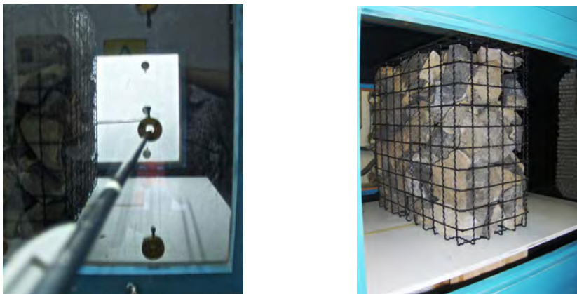
Figura 9.24: Derecha, muestra porosa y tubo Pitot. Izquierda, muestra porosa en túnel.
