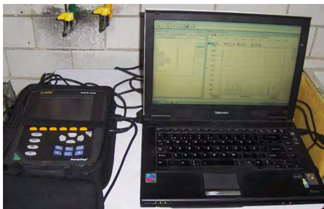
Figura A1.30: Analizador de energía durante prueba piloto para la medición de potencia. (Elaboración propia)
