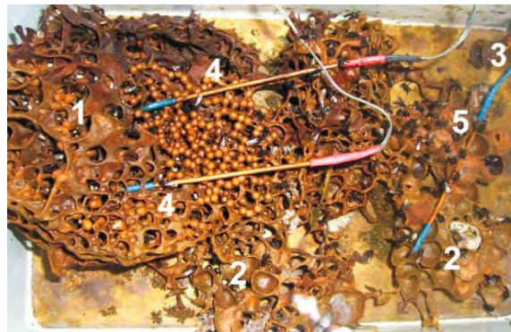
Figura 5.54: Contenedor con un nido de Trigona (frieseomelitta) nigra paupera . 1) área de cría, 2) área de almacén, 3) ducto de entrada, 4) sensores para área de cría, 5) sensor para área de almacén. Fuente: Torres, et al. 2009.
