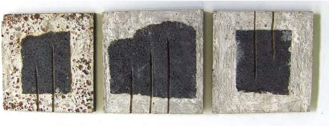
Figura A2.2: Ejemplo de ranurado de muestras para ubicación de termopares. (Elaboración propia)
