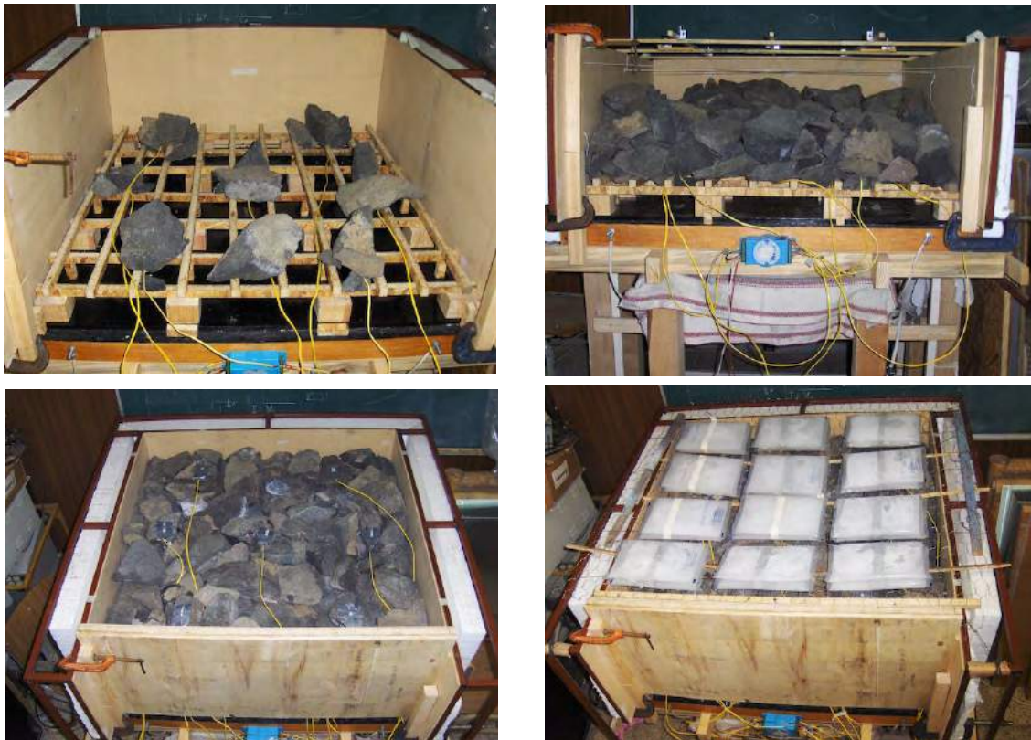
Figura 9.53: Arriba, muestras de basalto con termopares sobre bastidor. Abajo, llenado final, colocación de placa fría porosa y de la compuerta dejando libres 5 cm como entrada de aire. (Elaboración propia).
