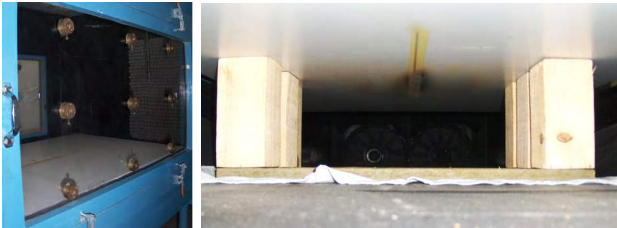
Figura 9.19: Izquierda, vista del área de pruebas del túnel de viento sin muestra de estudio. Derecha, vista de la base y apoyos para las muestras de estudio al interior del túnel. Se observa en la base la ranura central para poder producir un plano de luz, para las mediciones de velocidad se obstruye con cinta para que no altere los resultados. (Elaboración propia)
