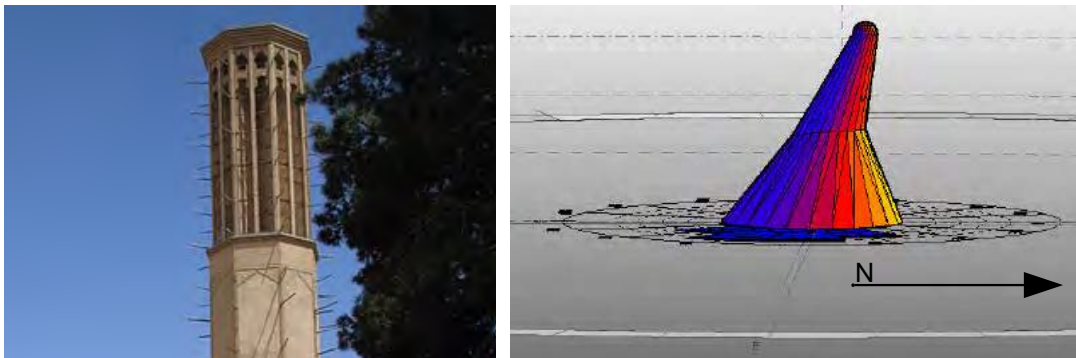
Figura 5.26: Captador de viento, Irán, Fuente: Wikipedia. Y modelo tridimensional de un montículo Macrotermes michaelseni con inclinación Norte de 20° y 3m de h, para evaluar el gradiente de presión. (Elaboración propia)
