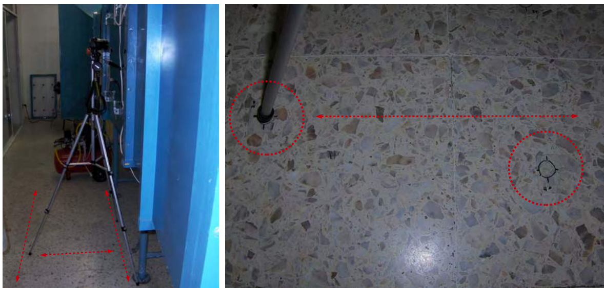
Figura 9.30: Izquierda, ubicación de cámara fotográfica. Derecha: Ubicación de puntos para desplazamiento de cámara entre planos y secciones de estos. (Elaboración propia)
