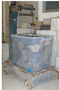
Figura 9.5: Arriba, depósito de 83 lt. Izquierda, probeta y jarra metálica. Centro, báscula de plataforma. Derecha, nivel de burbujas, depósito de 16 lt y piedra braza. (Elaboración propia)
