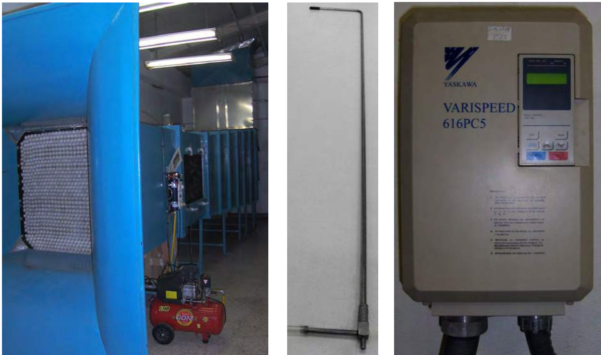
Figura 9.13: Izquierda, túnel de viento UAM-A. Centro, tubo Pitot tipo L. Derecha, variador de velocidad, Yaskawa 616PC5. (Elaboración propia)
