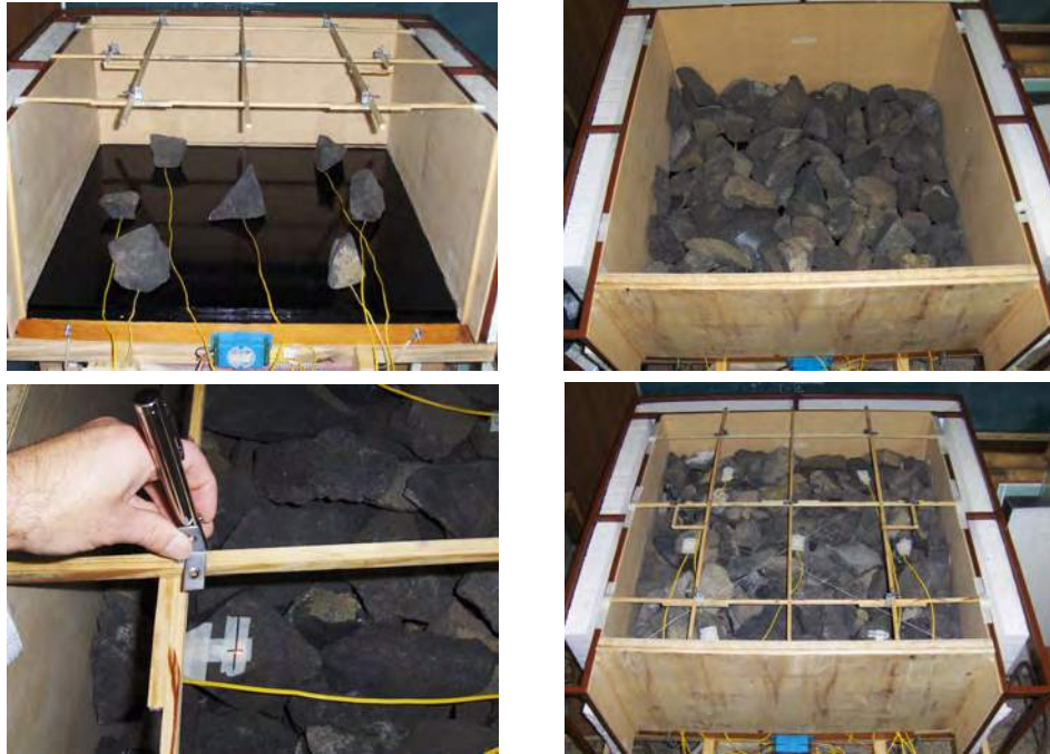
Figura 9.48: Arriba, llenado de gavión dentro del conductímetro desde los termopares ubicados en la placa caliente. Abajo, verificación de la ubicación de los termopares y llenado de la capa final junto con los termopares superiores. (Elaboración propia)
