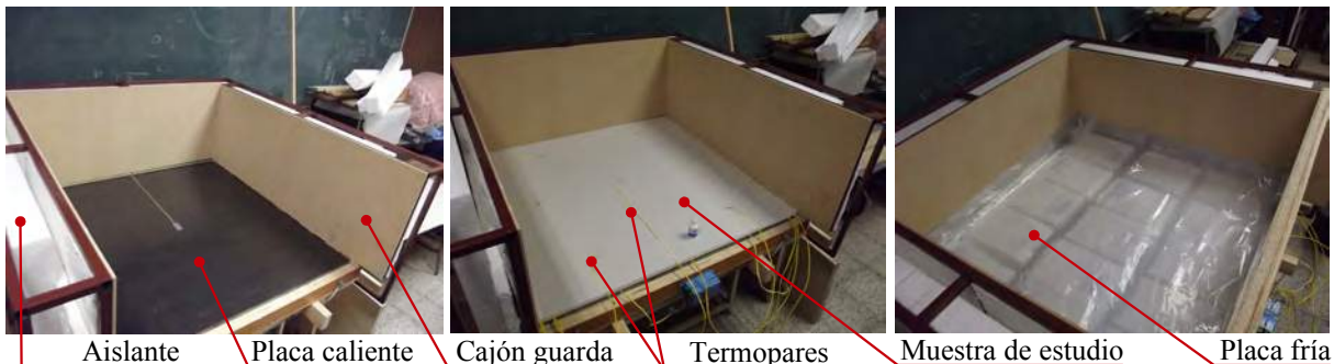
Figura A1.2: Conductímetro de placa caliente guardada de gran formato (Terres Martínez, 2015). Imágenes cortesía de Guillermo Terres.
