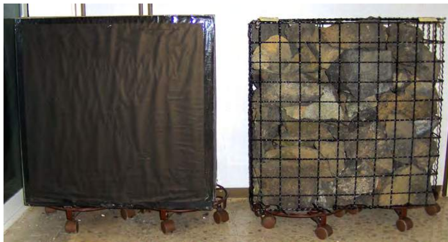
Figura 9.12: Gavión de piedras como prototipo de envolvente porosa y muestra sólida a partir de forrar con un material rígido la muestra original. (Elaboración propia)
