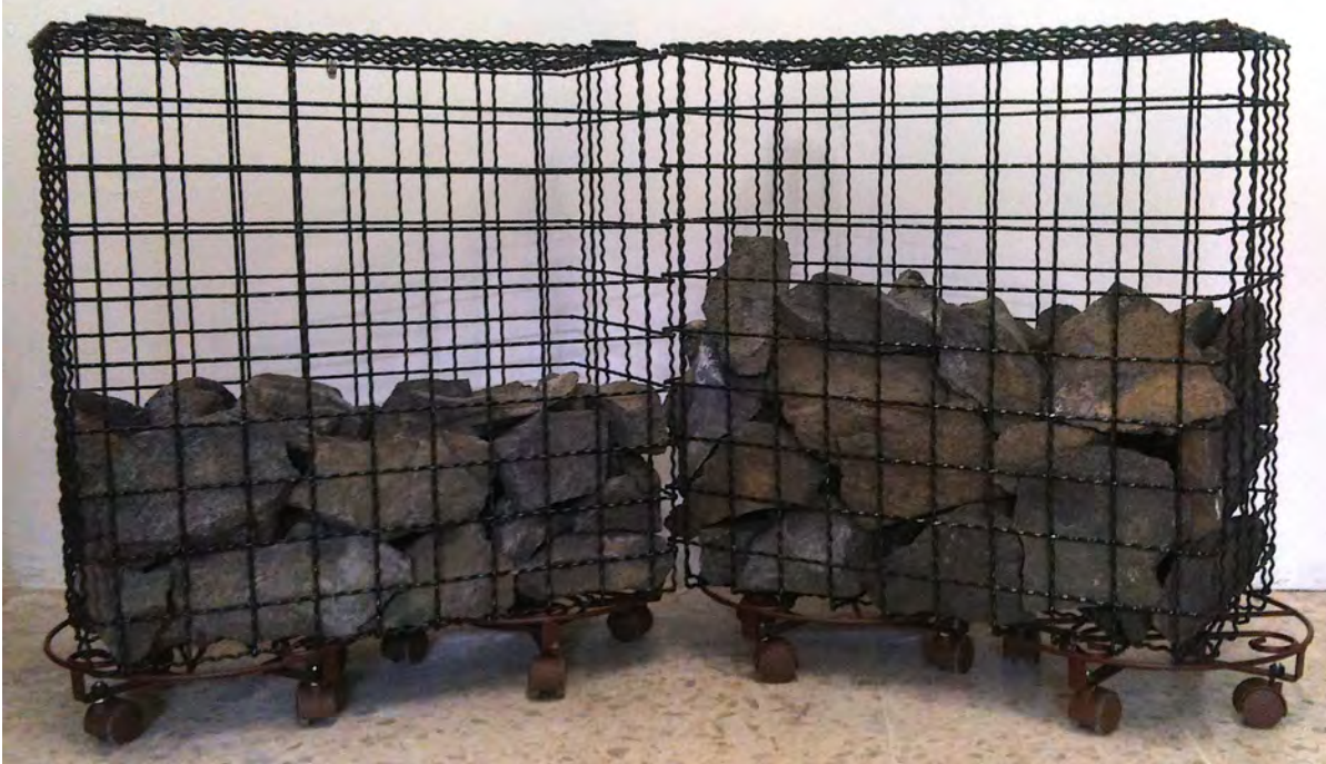
Figura 9.2: Gaviones de piedra de 0.60 X 0.60 X 0.30 m, como muestra de estudio de una envolvente porosa. Rejilla rígida a partir de malla galvanizada de 5 cm de abertura y 3 mm de espesor. Rellena de roca tipo basalto de tamaños aproximados 10, 15 y 20 cm. (Elaboración propia)
