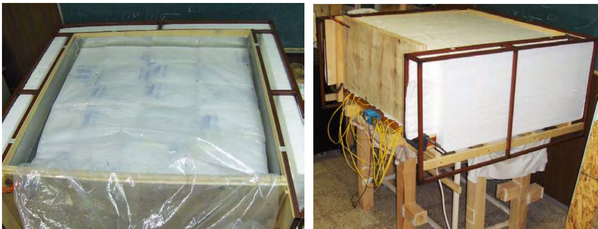
Figura 9.49: Izquierda, colocación de la placa fría compuesta por la bandeja de aluminio y la doble capa de bolsas de gel congelado. Derecha, vista general del conductímetro con la tapa superior a base de poliestireno, se observan los apoyos perimetrales a base de barrotes de madera para asegurar la integridad del equipo expuesto a más de 300kg de peso. (Elaboración propia)
