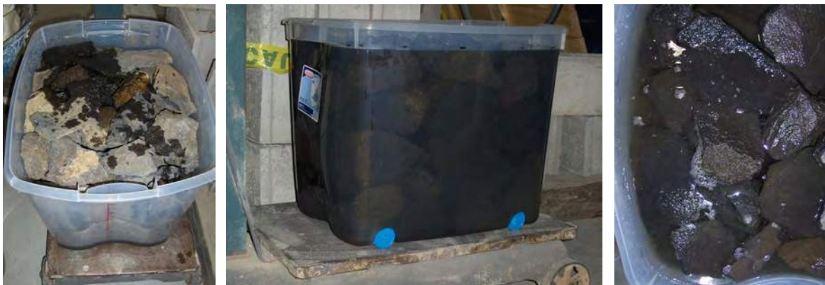
Figura 9.7: Izquierda y centro, agregado de agua en muestra. Derecha, burbujas en muestra después de vibrado.
