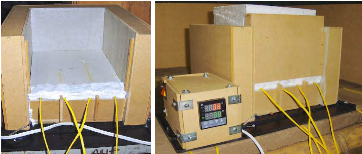
Figura A1.27: Izquierda, muestra de tablaroca y ubicación de termopares sobre la cara expuesta a la placa fría. Derecha, equipo durante calibración, se observa la tapa aislante. (Elaboración propia)
