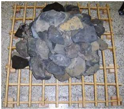
Figura 9.51: Bastidor para evaluación térmica durante la prueba de carga, misma que se llevó a cabo durante 24hr. El espacio libre entre los travesaños es aproximadamente de 10cm en su menor dimensión. (Elaboración propia).
