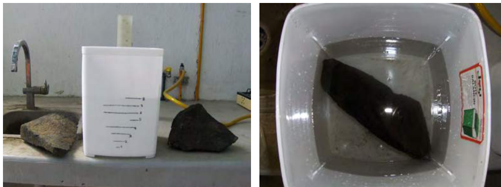
Figura 9.9: Izquierda, depósito graduado a 7 y 8 lt. Y muestras de basalto para estimación de densidad y porcentaje de absorción. Derecha, Muestra número 2 en depósito.
