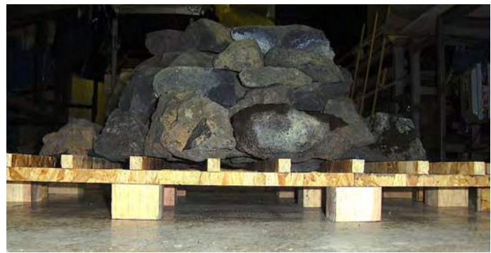
Figura 9.51: Bastidor para evaluación térmica durante la prueba de carga, misma que se llevó a cabo durante 24hr. El espacio libre entre los travesaños es aproximadamente de 10cm en su menor dimensión. (Elaboración propia).
