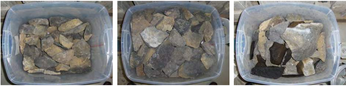
Figura 9.6: Llenado de muestras para determinar el coeficiente de porosidad. De izquierda a derecha, muestra 1, 2 y 3. Una vez alcanzada la marca de los 81 lt se pesó cada una de las muestras utilizando la báscula de plataforma.
