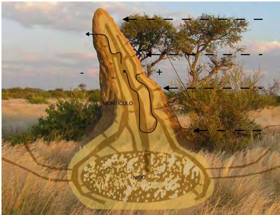
Figura 5.19: Distribución de la presión ejercida sobre el montículo según Turner. Imagen base: Grohmann, 2010.
