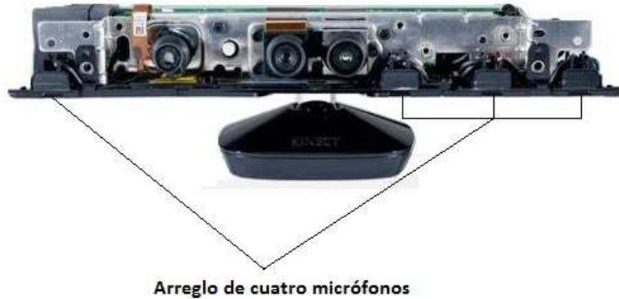
Figura 47. Distribución de micrófonos en el sensor Kinect
