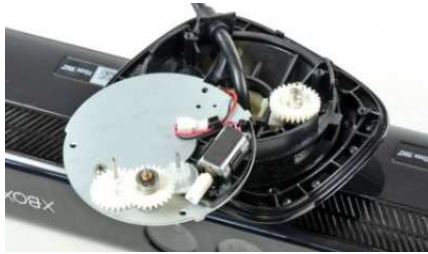
Figura 50. Motor en la base del Kinect para tilt (inclinación)
