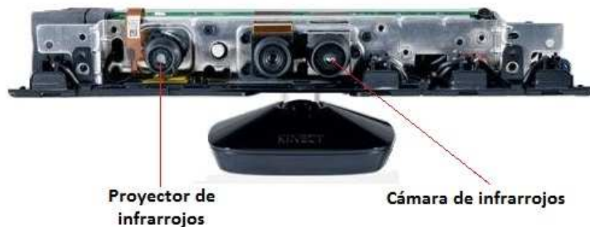
Figura 41. Vista frontal del sensor Kinect sin carcasa
