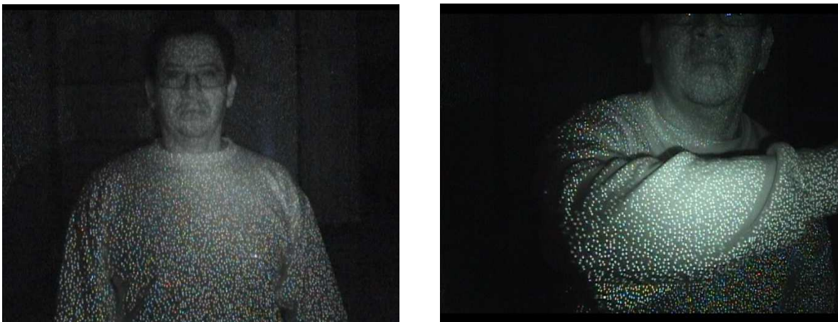
Figura 44. Puntos luminosos generados por el proyector de IR del sensor Kinect captados con una cámara de visión infrarroja
