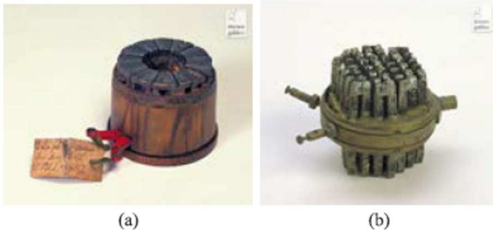
Figura 17. Las termopilas de Nobili-Meloni: (a) Prototipo de termopila inventado por Nobili (1829), (b) Versión incompleta de la termopila Nobili-Meloni (1831). Museo Galileo-Institute y Museum of the History of Science, Piazza dei Giudici 1, 50122 Florencia, Italia
