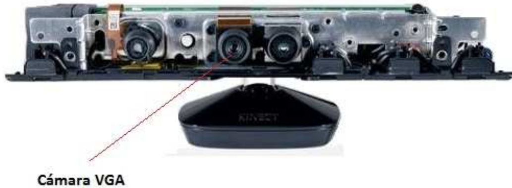
Figura 48. Ubicación de la cámara VGA en el Kinect
