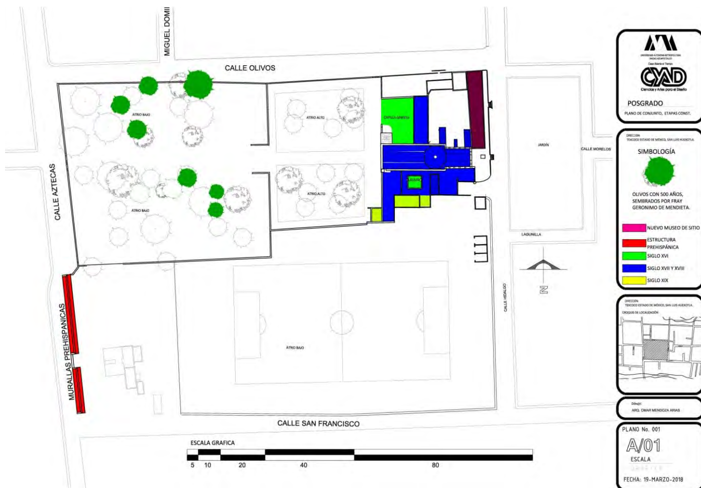
Plano inédito 13. Planta arquitectónica de conjunto, Templo de San Luis Obispo, indicando etapas constructivas
