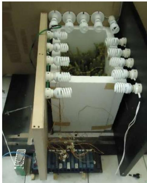
Figura 23 Simulador de radiación solar ya adaptado para aporta los niveles de radiación PAR bajo los cuales funciona una muestra de techo verde.
