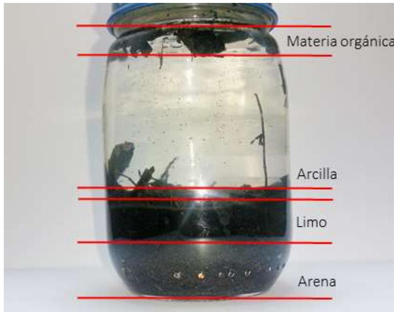
Figura 16 Muestra de sustrato mezcla 1 después de 24hrs
