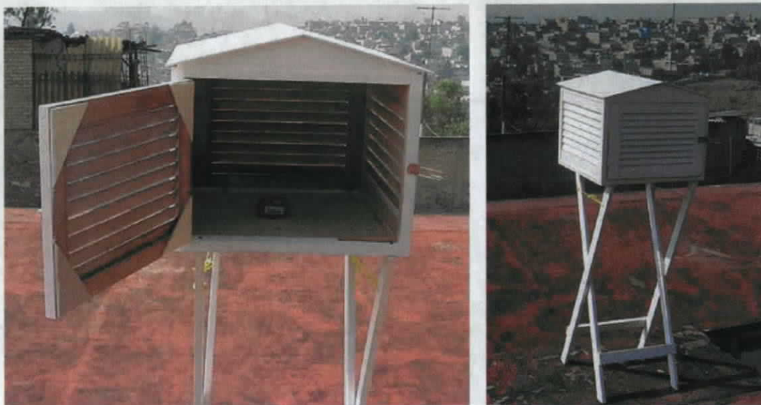
Figura 77 y 78 Ubicación de estación de monitoreo exterior de temperaturas en aulas de la muestra.
